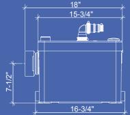
**Power/Amperage:** 115V / 60 Hz / 4.5 A **HP:**
