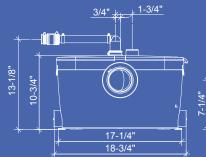
**Power/Amperage:** 115V / 60 Hz / 4.5 A **HP:**
